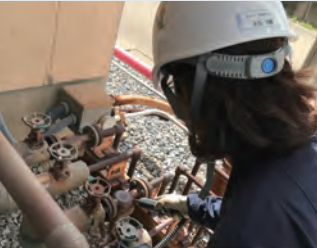
スチームトラップの漏れ測定
