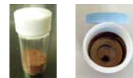
粉体 パスト 用途:EVで利用されるパワー半導体の高耐熱接合
